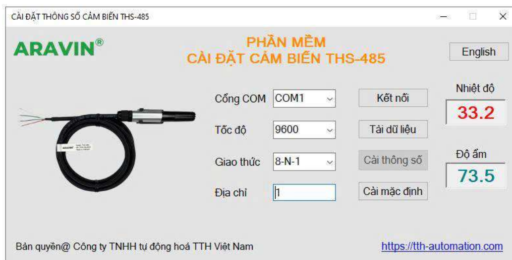
Giao diện tiếng Việt của phần mềm cấu hình cảm biến THS-485
